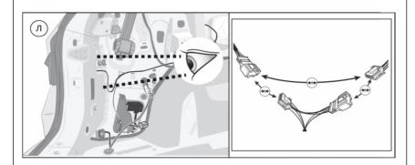
Жгут электрики фаркопа (длинный жгут с разъемами) протянуть вдоль задней панели к правому фонарю.
