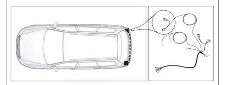
Достать из фонаря приходящий разъем, взамен установить разъем электрики. Штатный разъем установить в ответный разъем электрики фаркопа.
