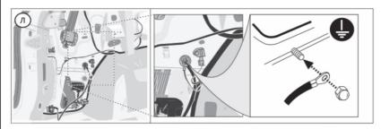
Монтаж блока согласования на кузов автомобиля. Приклеить блок к кузову автомобиля на двусторонний скотч, необходимо соблюсти правильное положение в пространстве (Разъемом вниз).
