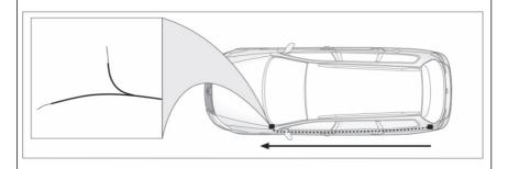
Для подключения задней противотуманной фары(птф) необходимо снять пластиковую накладку нижней части передней левой стойки.
