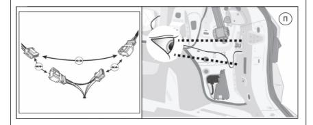
Протянуть питание электрики фаркопа и провод задней птф (объеденены в один жгут) вдоль левого порога к торпедо автомобиля.
