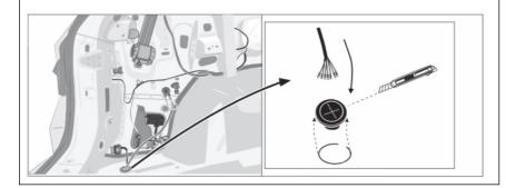
Жгут розетки проложить как можно дальше от элементов выхлопной системы. Не допускать плавления изоляции жгута.
